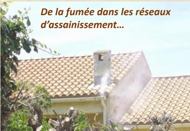
Dans le cadre du diagnostic du réseau d'assainissement, la CABM, via son prestataire ASSAINISSEMENT 34, a procédé à des tests à la fumée les 8 et 9 Septembre. Cette opération permet de vérifier le bon raccordement des eaux pluviales au niveau des toitures des maisons, mais aussi au niveau des grilles et avaloirs de la chaussée. La zone Ouest de la commune était ciblée.
